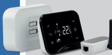
В отсутствии связи с сервером SALUS, терморегуляторы продолжают работать как обычные беспроводные терморегуляторы, и будут поддерживать ту температуру, которая отражалась в настройках на момент исчезновения связи.
